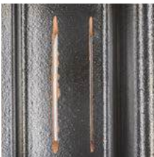
ultradünne Schnittkante im Vergleich mit herkömmlichen Scheiben
