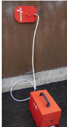
Vakuumpumpe anschließen 0,2 kg
