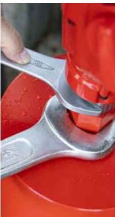
Bohrkrone aufschrauben Ø 150 mm - 3,7 kg
